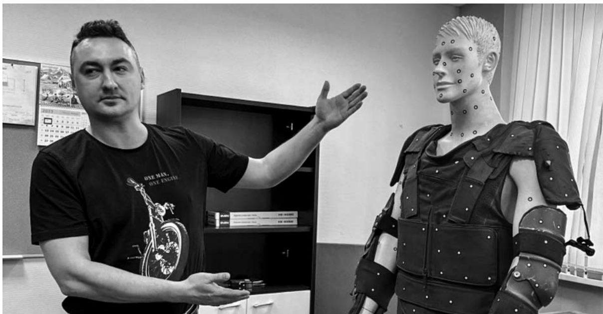
✎ Николай Шишкин, ООО «Машиностроение»: «На манекене вы видите самую простую систему экзоскелета. Его основой служит легкая броня, на которую предполагается монтаж дополнительной оснастки, позволяющей снижать нагрузку на ноги, руки, поясницу, чтобы человек мог ощущать себя в безопасности и меньше уставать во время активных действий».
