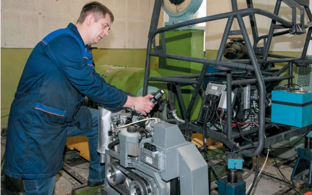
■ Отличительными особенностями технических решений, предложенных учеными ТГУ, являются максимальная унификация конструкции удлинителя пробега с существующей компонентной базой, доступной на автомобильном рынке, минимальное вмешательство в конструкцию силового агрегата, технологичность и простота изготовления REEV.
