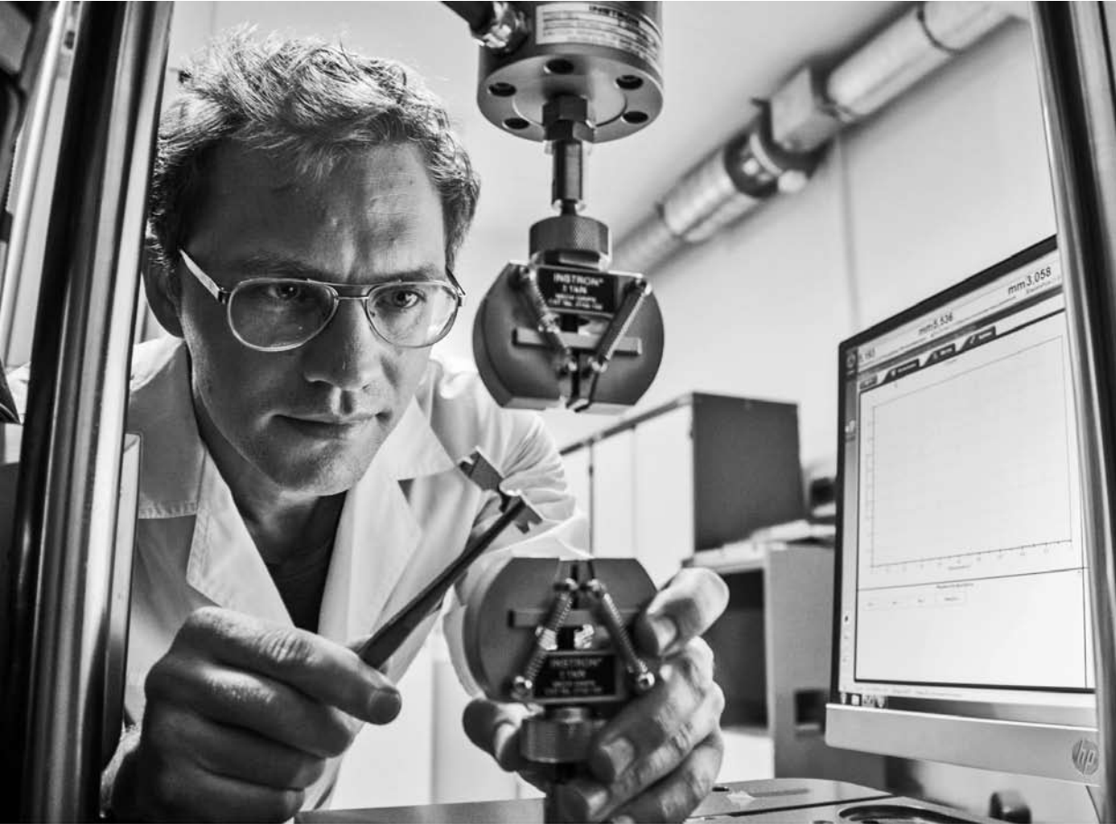
Долговечность работы магниевых сплавов в коррозионной среде ученые Тольяттинского госуниверситета проверяют на специально созданном в лабораториях оборудовании. Это позволяет контролировать качество созданных биорезорбируемых материалов, а также разрабатывать биомедицинские сплавы нового поколения.
