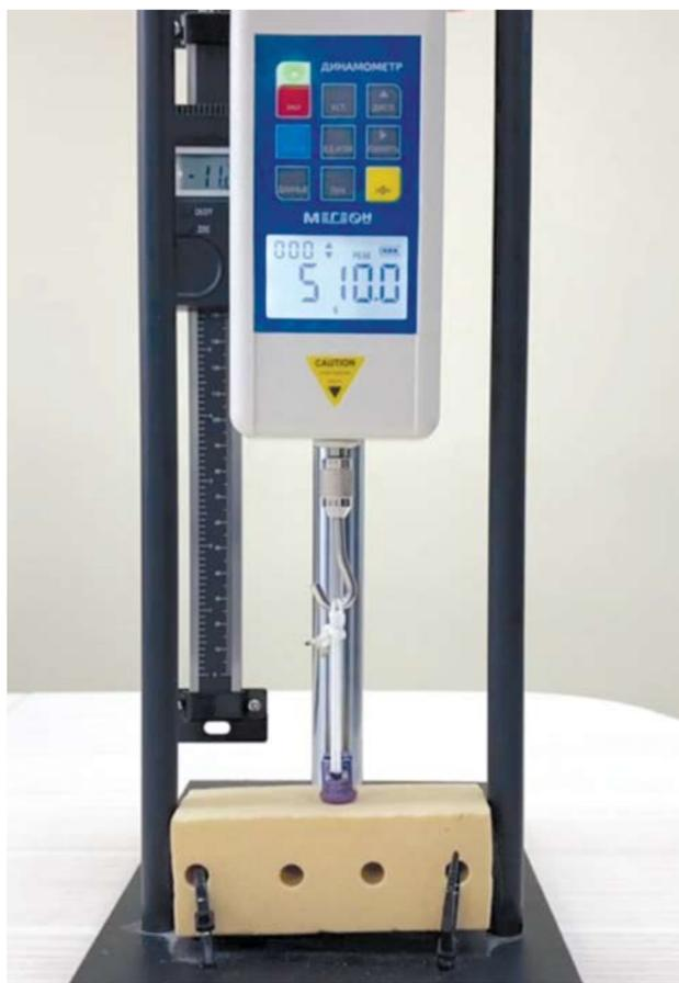
Испытания винта из биорезорбируемого магниевого сплава на стенде МЕГЕОН 03000В.
